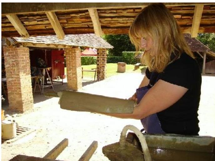
L'ouvrier sablait le plan de travail sur lequel la forme était posée. Il la remplissait de terre et enlevait l'excédent. La surface était égalisée à l'aide de la « *planette* » mouillée. La forme était ensuite déposée sur une planche et le goujat (apprenti) réalisait le crochet. Les tuiles étaient déposées sur le sol de terre battue, au soleil, pour les faire sécher.
